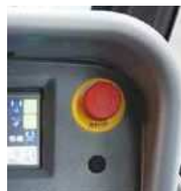
(クレーン作業時のみ機能)
